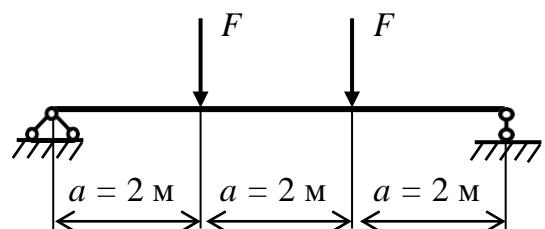
**Задача № 3.** На балку действуют две силы:  $F_1 = 12$  кН в вертикальной плоскости  $xy$  и  $F_2 = 8$  кН в горизонтальной плоскости  $xz$ . Из условия прочности при косом изгибе определить размеры прямоугольного сечения балки с соотношением сторон  $h/b = 2$ .
