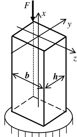
**Задача № 14.** Определить наибольшее напряжение сжатия в стержне, внецентренно сжатом силой  $F = 160 \text{ кН}$ .
