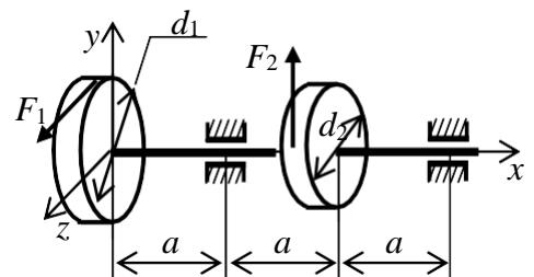
**Задача № 10.** Вал, на который насажены два шкива, вращается с постоянной угловой скоростью. Требуется:
