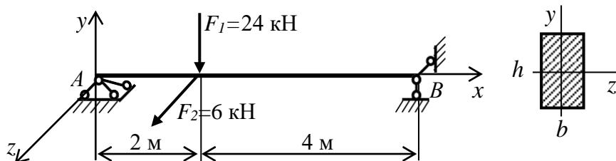
**Задача № 8.** Для вала механической передачи:
